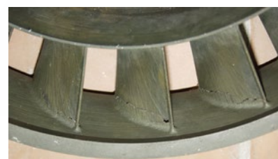
Трещины в отливке (АО «ОДК» – «Салют»)
